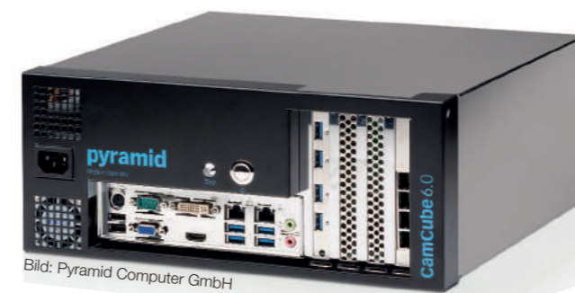
Bild 2 | Der modulare High-Performance-Industrie-PC CamCube 6.0 der Pyramid Computer GmbH steuert die Bildverarbeitung der Roboter von pi4.
